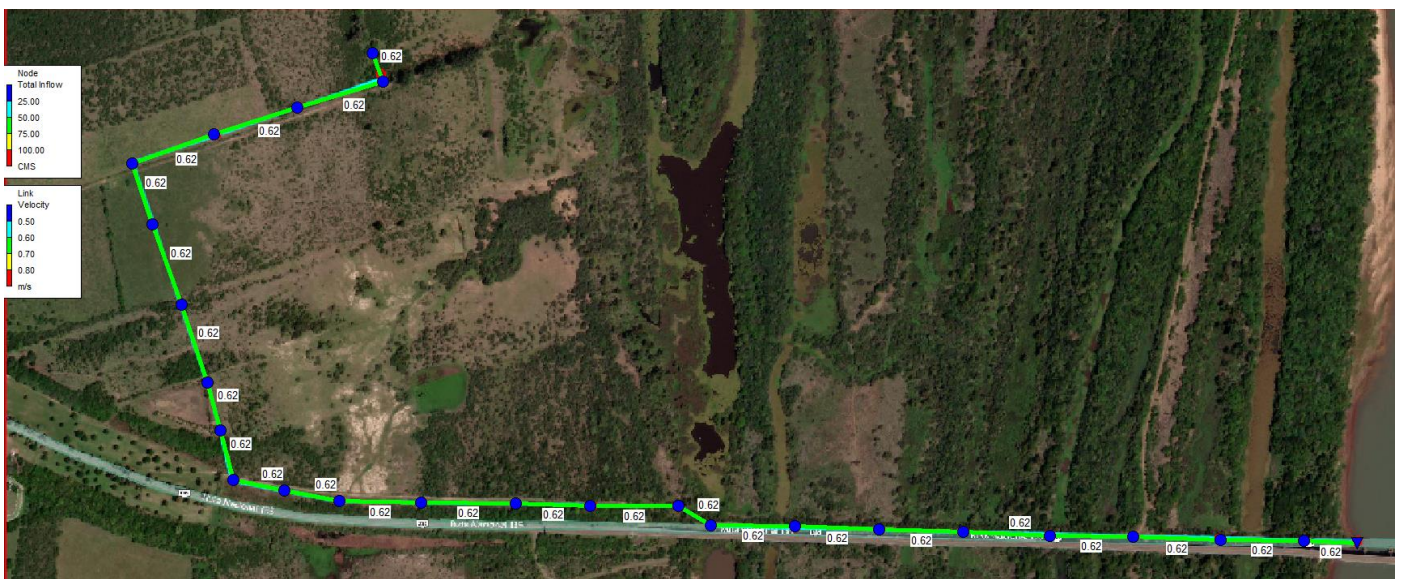
Figura 69 Mapa de valores de velocidad en conductos. Escenario 1.
