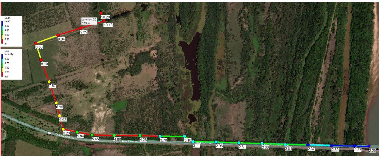
Figura 74 Mapa de valores de nivel piezométrico en nodos. Escenario 2.
